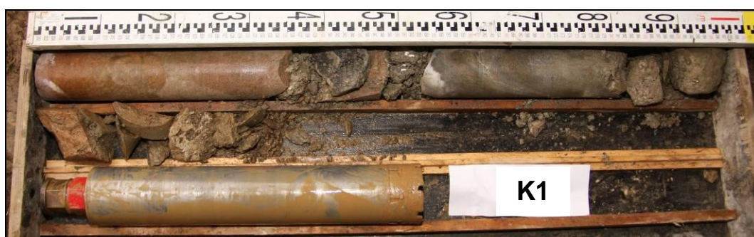
Obr. č. 3 - diagnostický vrt K1 - klenba
