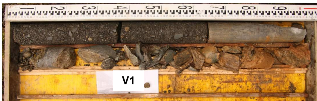
Obr. č. 1 - diagnostický vrt V1 - opěra Libina
